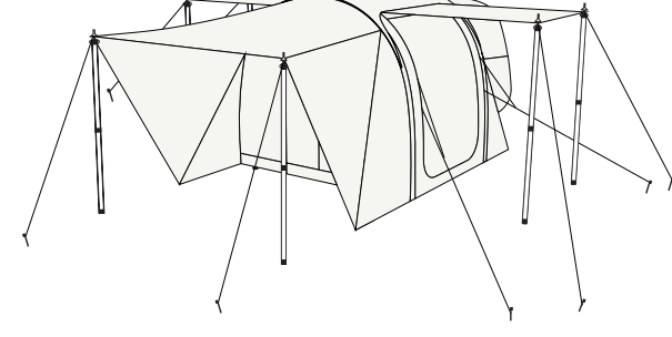
8. 将上端织带插入门厅杆上方，下端织带可直接用地钉固定。
