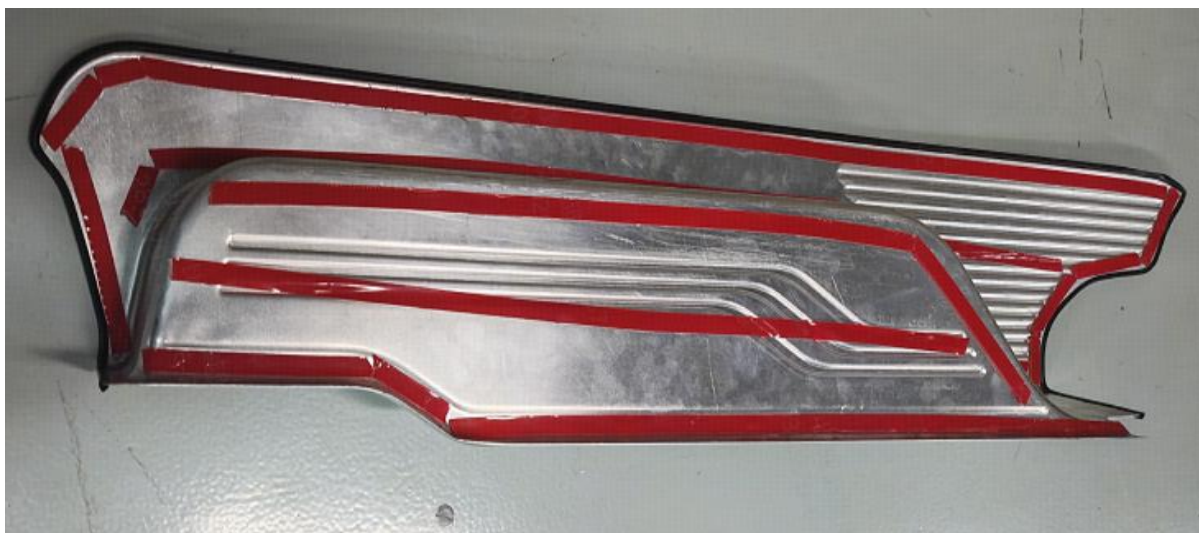
2.4 对准位置：踏板两侧与车辆内饰板贴合，车门密封胶条刚好卡在踏板避让开口处；用力按压踏板，使得踏板与原车踏板牢固贴合。
