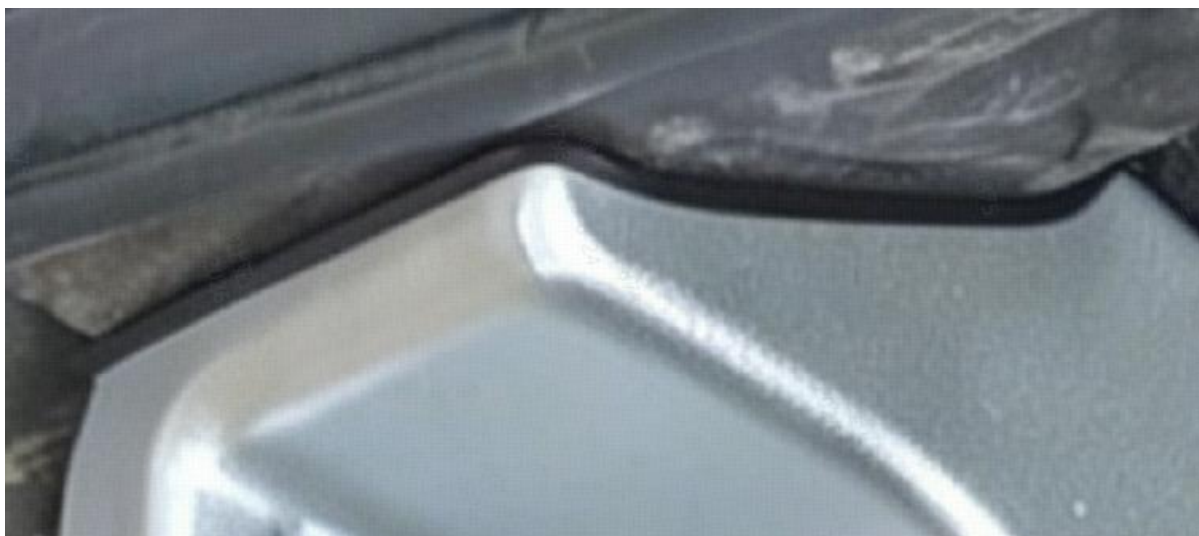
2.4 对准位置：踏板两侧与车辆内饰板贴合，车门密封胶条刚好卡在踏板避让开口处；用力按压踏板，使得踏板与原车踏板牢固贴合。
